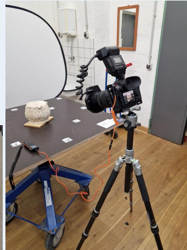
Geometrische Auflösung: 0,3 mm Punktabstand Texturauflösung: 0,06mm (1:1 bei 400 dpi) (Tachymetrische Passpunktmessung)
