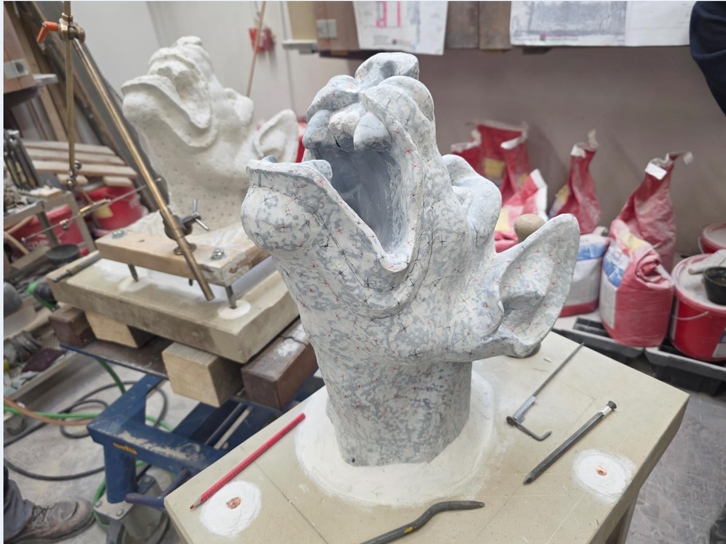
Rechts: 3D-Druck (SfM-Modell) mit Ergänzungen Links: Bearbeitungszwischenstand (Kopie mit Messarm)
