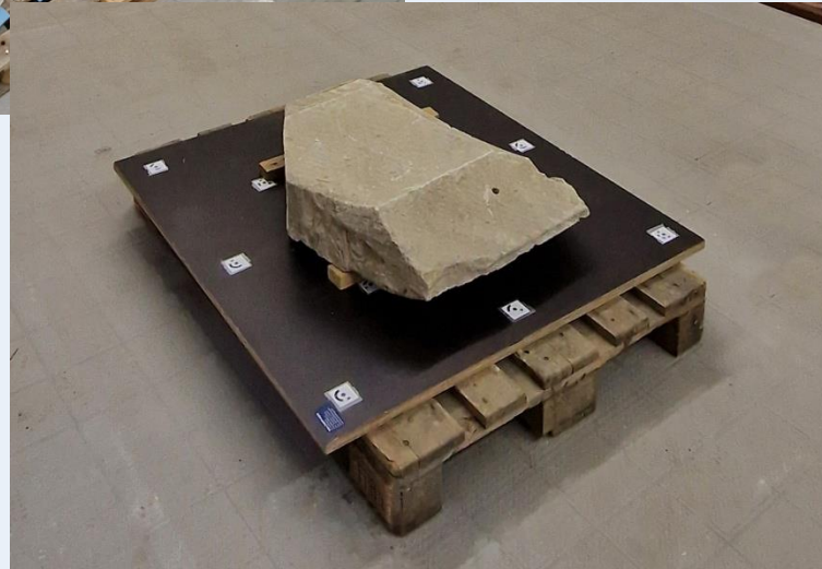
Geometrische Auflösung: 0,3 mm Punktabstand Texturauflösung: 0,06mm (1:1 bei 400 dpi) (Tachymetrische Passpunktmessung)
