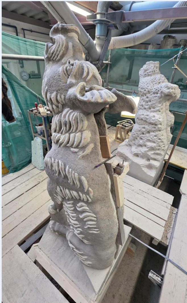
Links: verwitterter original Wasserspeier mit ergänzenden Antragungen Rechts: Bearbeitungszwischenstand (Kopie mit Messarm)
